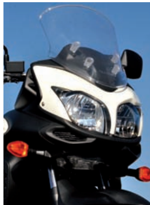
Seřiditelný větrný štítek nabízí velice slušnou ochranu před větrem. K výškovému nastavení je potřeba imbusový klíč.
