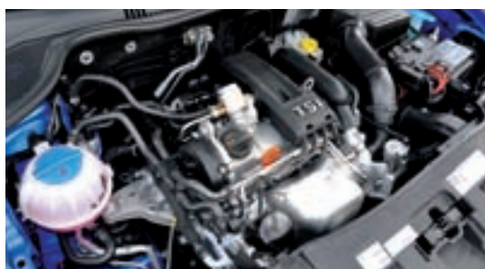
Přeplňovaný čtyřválec 1.2 disponuje 77 kW. Ibiza patří mezi nejlehčí automobily své třídy a tak nabízí zajímavé dynamické vlastnosti.
