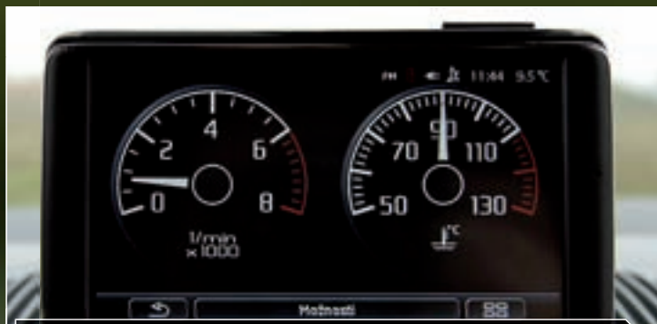
Přenosná navigace Navigon, která má v sobě integrovanou komunikaci s vozidlem. Zobrazovat tak umí navíc podrobné údaje z palubního počítače nebo teploměr chladicí kapaliny.
