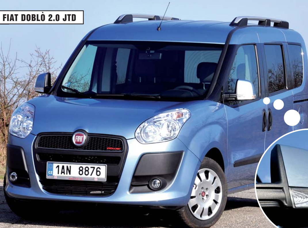
Ukazatele směru se přestěhovaly do zpětných zrcátek.
