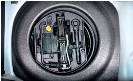
Pod dnem zavazadlového prostoru je souprava pro nouzovou opravu pneumatik.
