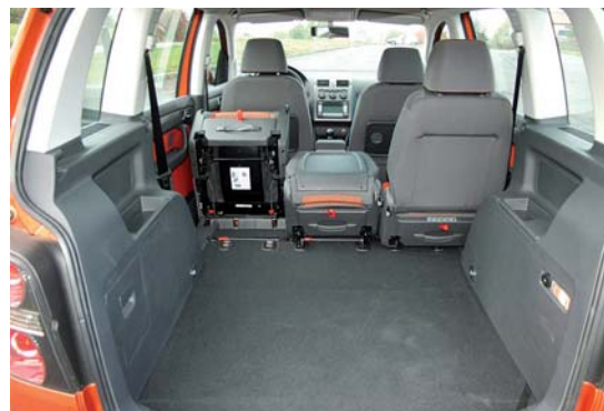
V základním uspořádání pětimístného touranu má zavazadlový prostor objem 650 l. Po sklopení sedadel dokonce 1558 l.
