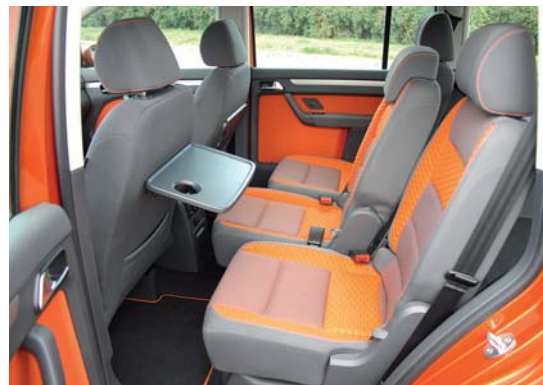
Sedadla druhé řady lze posouvat, měnit sklon opěradla, sklápět nebo z vozu zcela vyjmout.
